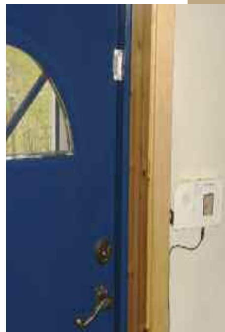
En huskeboks hvor man kan lese inn korte beskjeder. Foto: Hjälpmedelsinstitutet Sverige
